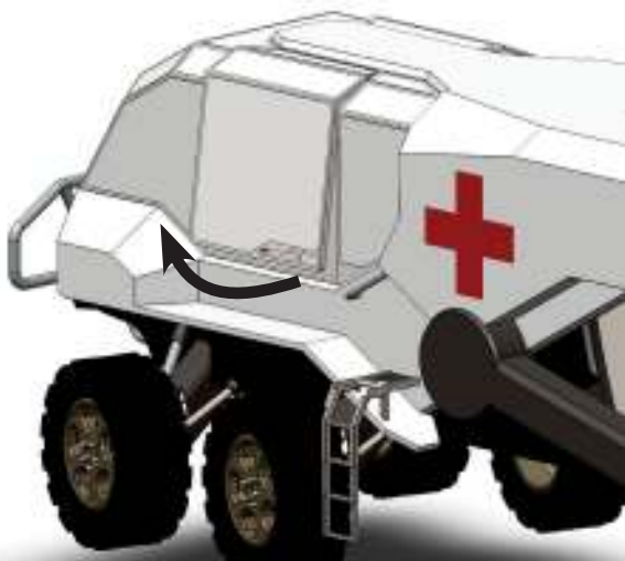
Zugang zur Fahrerkabine und Funktionsweise der Türen
